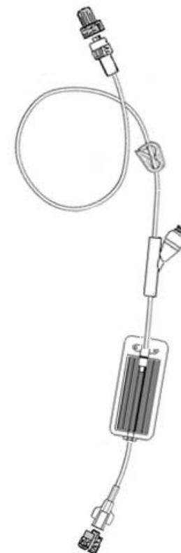
Prolunghe con filtro particellare da 0.2 micron in linea, attacchi L.L.M. girevole e L.L.F.. Le particolari caratteristiche costruttive dell'estensione garantiscono al sistema la massima flessibilità ed elasticità, oltre a consentire la massima trasparenza per il controllo del flusso. Il sistema è in grado di resistere a pressioni temporanee massime di 56 P.S.I. (4 Bar). Collegare la prolunga al set di somministrazione e fare defluire la soluzione per liberarlo dall'aria nel circuito.
